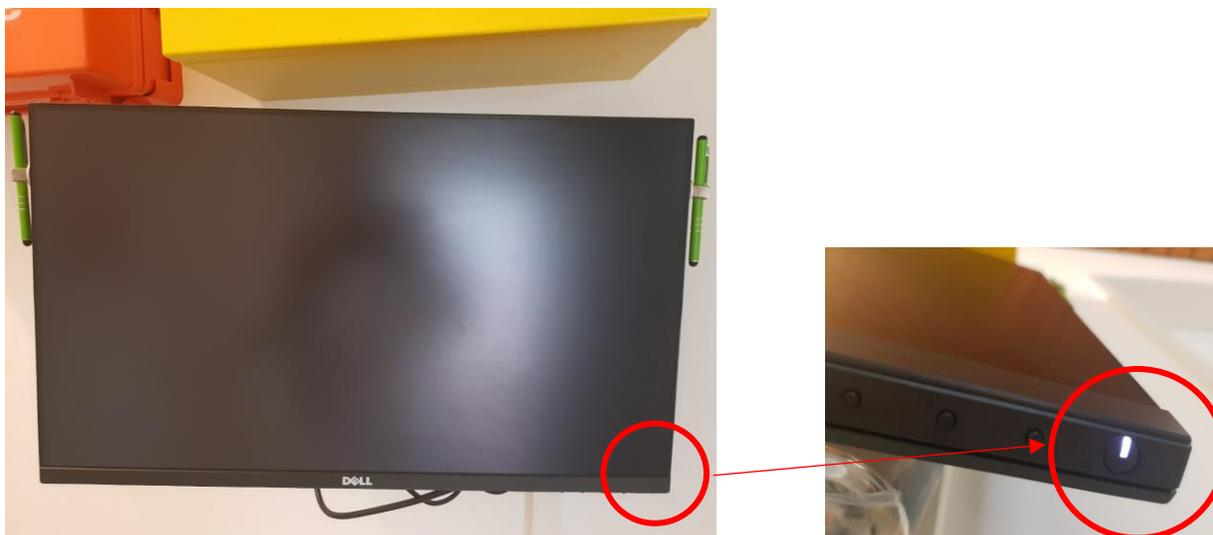
Ist der Bildschirm ausgeschaltet, findet man an der unteren rechten Ecke einen An/Aus-Schalter.
